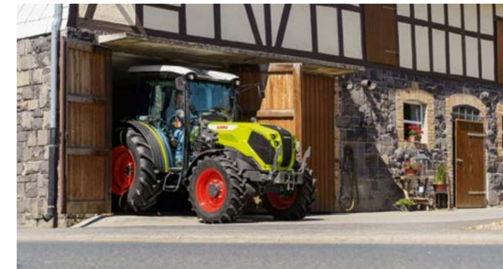
In sehr breiten Obstplantagen oder Weinbergen ist der ELIOS 200 ein idealer Partner. Die optionale schmale Vorderachse und die passende Bereifung ermöglichen eine Gesamtbreite von nur 1,65 m.
