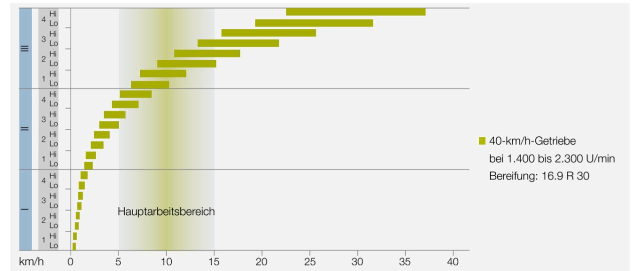
Die 24 Gänge bieten für alle Arbeiten die richtige Geschwindigkeit. Mit einer Minimalgeschwindigkeit von 500 m/h bei Nenn-drehzahl meistern Sie auch Spezialanwendungen perfekt. Die TWINSHIFT Lastschaltung wird ganz einfach per Knopfdruck am Schaltknäuf betätigt. Alle Getriebe des ELIOS wurden entwickelt, um niedrige Kraftverluste zu gewährleisten.
