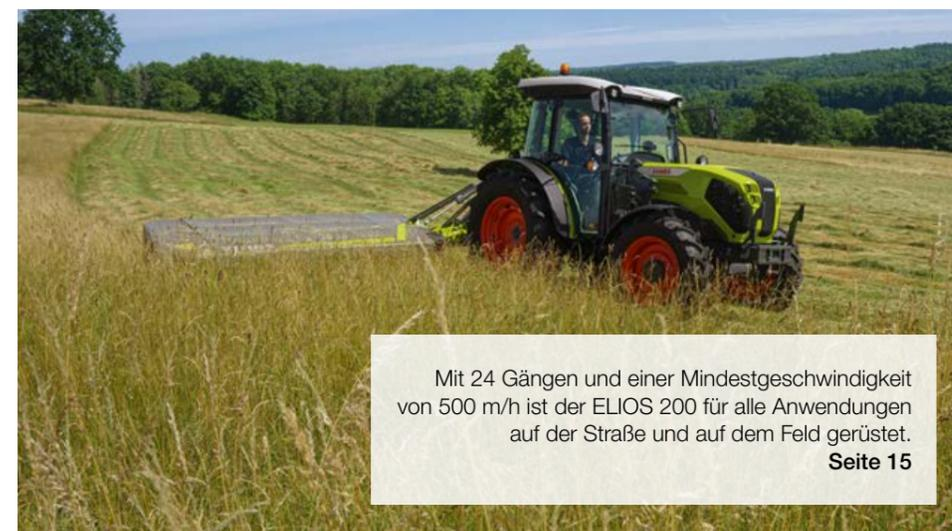
Mit 24 Gängen und einer Mindestgeschwindigkeit von 500 m/h ist der ELIOS 200 für alle Anwendungen auf der Straße und auf dem Feld gerüstet.
